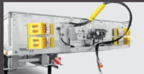
Anschlüsse für Luft- und Elektroversorgung zur SZM an der Vorderwand
