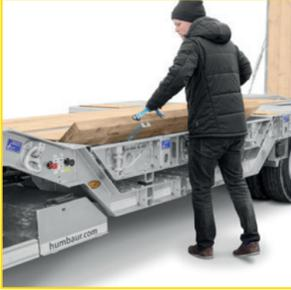
Die Radmulden lassen sich bei Bedarf einfach und flexibel freilegen. Genügend Stauraum sorgt für die einfache Unterbringung der Bohlen.
