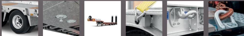
3. Achse als Nachlaufenkachse | Umschraubbarer Königszapfen für 2- und 3-Achs-SZM | Außenrahmen feuerverzinkt und lackiert in RAL | Außenrahmen mit integrierten Zurrpunkten (klappbar) | In den Außenrahmen geschraubte Zurrösen (klappbar) | 10 t Zurrpunkte
