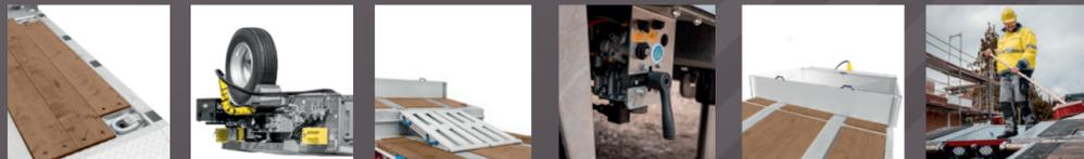
Rungentaschenpaket im Außenrahmen | Galgen für Versorgungsleitungen | Rampenschiene für Alu-Rampen | Luftfederung mit Hub- und Senkeinrichtung | Aluminium-Bordwände am erhöhten Plateau mit Staukasten | Gummibodenbelag
