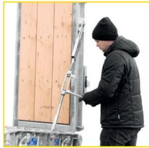
Über leicht zu bedienende Spannschlösser lassen sich die Rampen schnell sichern.
