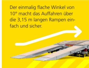
Der einmalig flache Winkel von 10° macht das Auffahren über die 3,15 m langen Rampen einfach und sicher.
