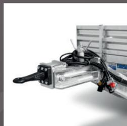
Schwenkzugöse mit Durchmesser 40/50 mm Zugöse
