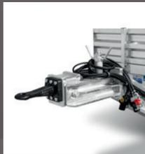
Schwenkzugöse mit Durchmesser 40/50 mm Zugöse
