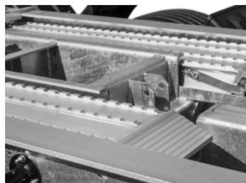
Optionale Aluminium-Auffahrampen mit patentierter Verriegelung
