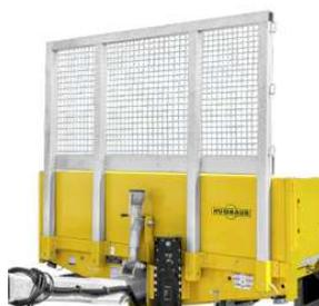
Vorderwand mit Stahl-Gitteraufsatz, optional
