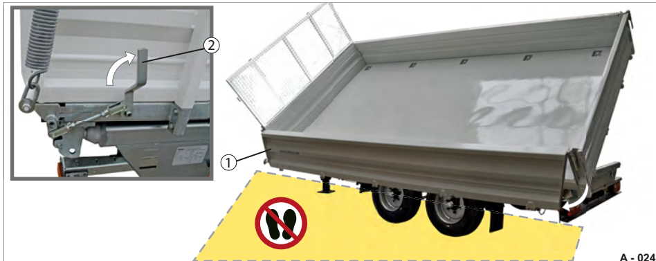
Abb. 26 Bordwand im Pendelbetrieb
