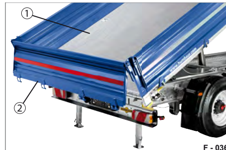
Abb. 59 Ladefläche komplett abgekippt
