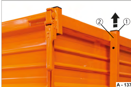
Abb. 143 Montage Auflagebock vorbereiten
