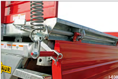
Abb. 41 Arretierung der seitliche Bordwände
