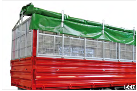
Abb. 50 Rollplane auf Stahlgitteraufbau
