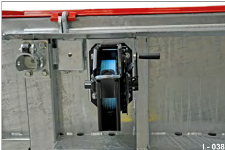
Abb. 35 Spanngurt-Winde (4x), unter der Ladebrücke angebracht
