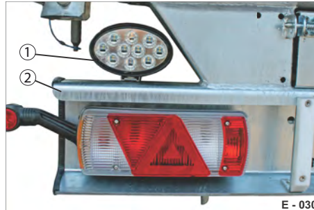
Abb. 25 Arbeitsleuchte am Heck; Rechts & Links außen
