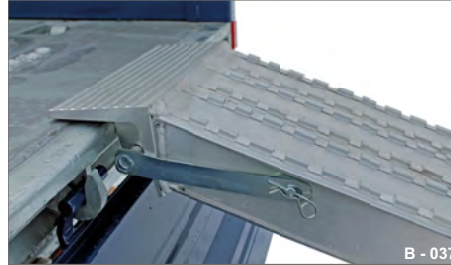
Abb. 8 Auffahrbohlen mit Sicherungshaken
