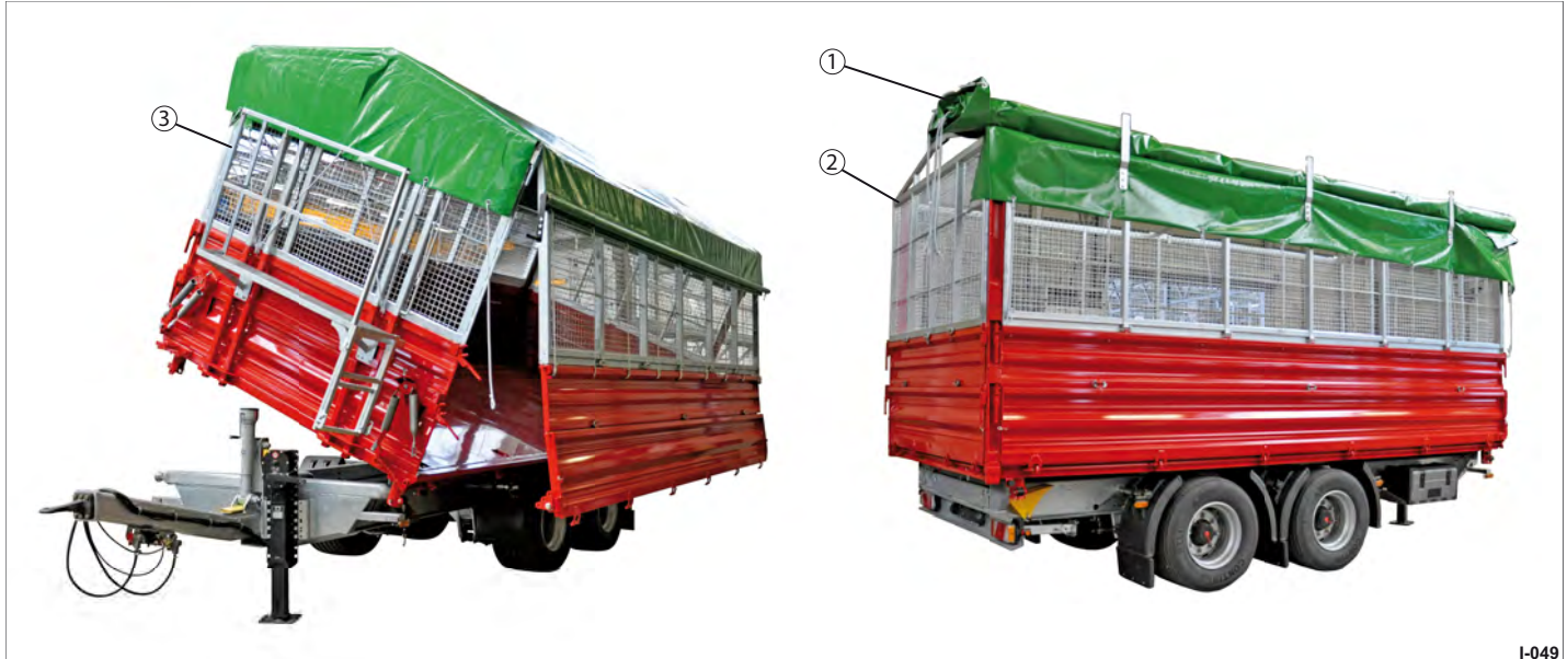
Abb. 9 HTK mit Stahlgitteraufbau und Rollplane
