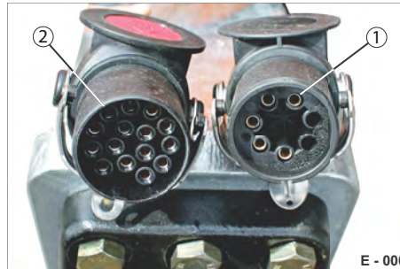
Abb. 2 Steckverbindungen, Standard 24 V
