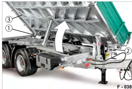
Abb. 61 Ladefläche seitlich abgekippt
