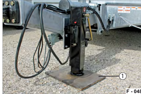
Abb. 68 Stützfuß stabilisiert 1 Stabile / Feste Unterlage
