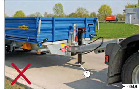
Abb. 69 Fahren mit abgelassenem Stützfuß 1 Stützfuß unten
