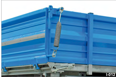
Abb. 11 Zugfedern für seitliche Bordwände
