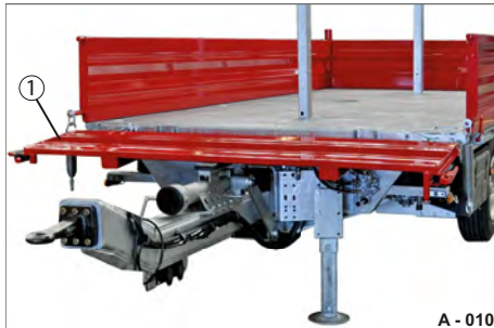
Abb. 6 Aufbau-Zubehör 1 Stirnbordwand, abklappbar
