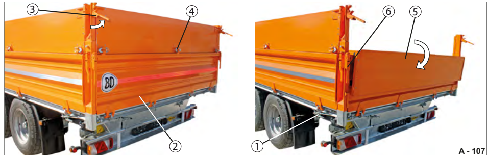
Abb. 114 Bordwandaufsatz heckseitig abgeklappt
