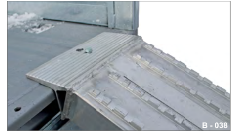
Abb. 172 Auffahrbohlen mit Sicherungsbolzen
