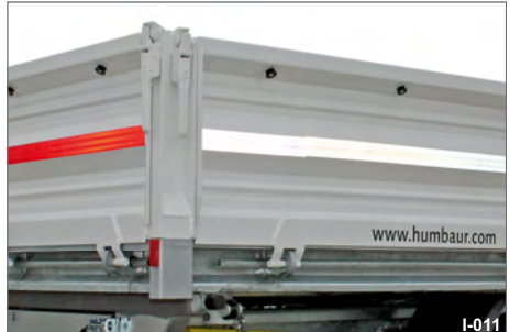
Abb. 15 Rundknöpfe an den Bordwänden
