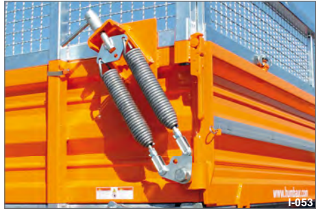
Abb. 51 für Abklapp-Betrieb mit Bordwand-aufsatz
