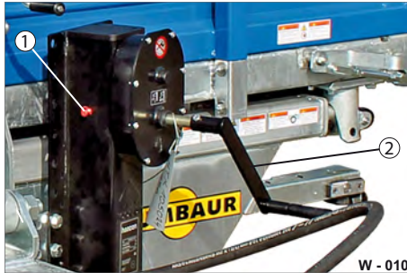
Abb. 10 Getriebebestützwinde am Fahrgestell
