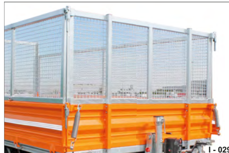
Abb. 19 auf die Grundbordwände aufgesetzt
