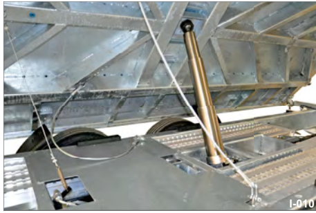
Abb. 12 Ladebrücke seitlich abgekippt
