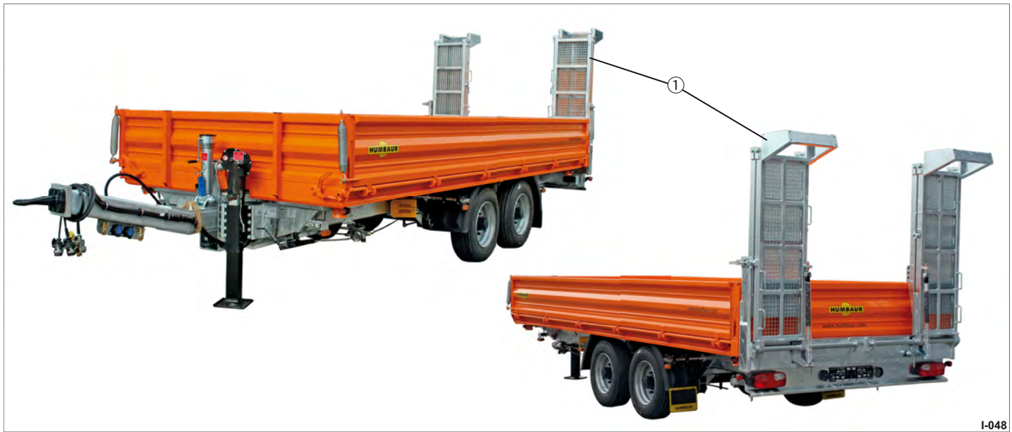
Abb. 8 HTK mit feststehenden Auffharrampen 1 Auffharrampen, zweigeteilt
