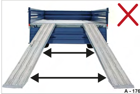
Abb. 184 Auffahrbohlen schräg angeordnet
