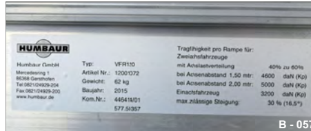
Abb. 9 Typenschild Auffahrbohlen VFR120
