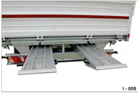
Abb. 10 Auffahrbohlenschächte im Fahrgestell
