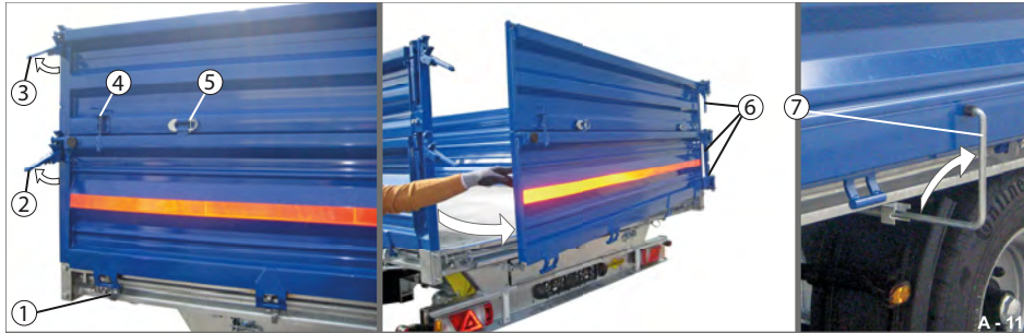
Abb. 118 Heck-Bordwand mit Bordwandaufsatz als Drehflügel öffnen
