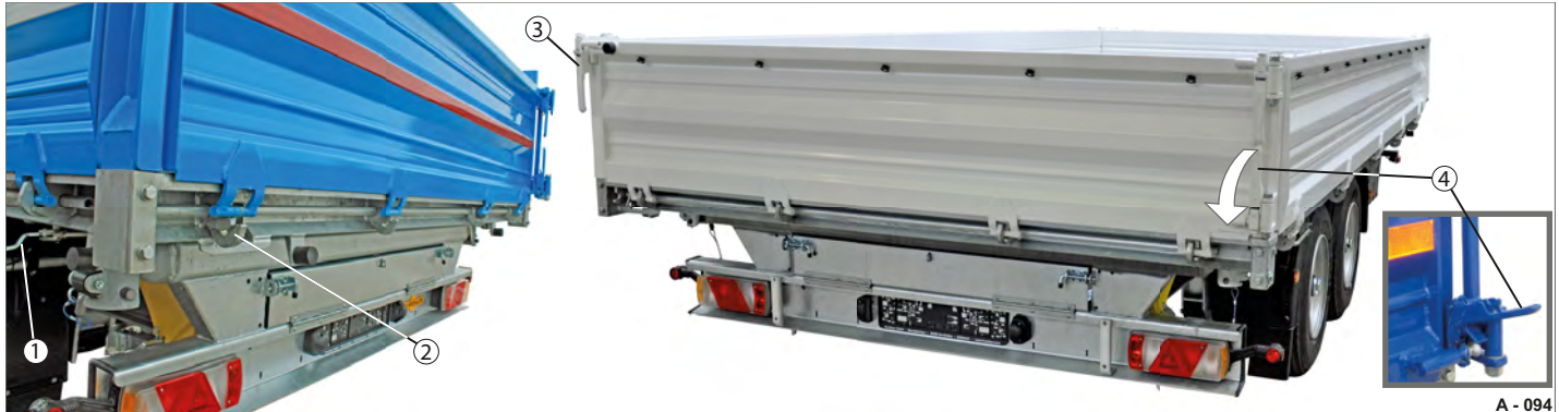
Abb. 68 Drehflügel im Pendel-Betrieb
